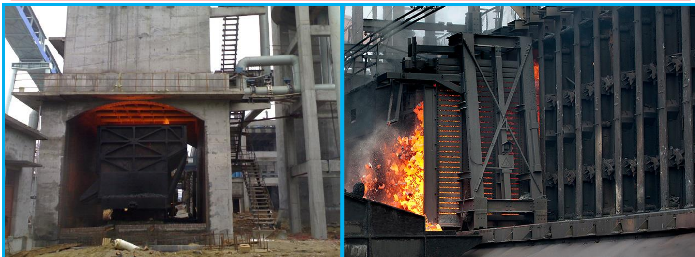
شکل ۲: تخلیه کک از درون سلول به داخل واگن ماشین کوئینچینگ (راست) و خاموش سازی کک در برج خاموش کننده (چپ)
