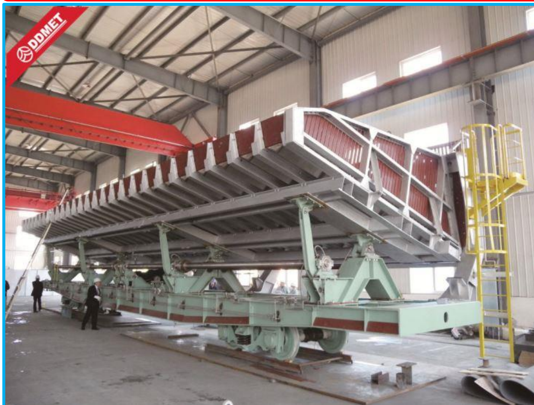
شکل ۸: استفاده از پوشش جهت کاهش میزان خوردگی در واگن ماشین Quenching
