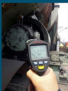
شکل ۴ - کانتور دما در سپرهای حرارتی و مقایسه با حالت واقعی (ترمومتر لیزری کالیبره شده)
