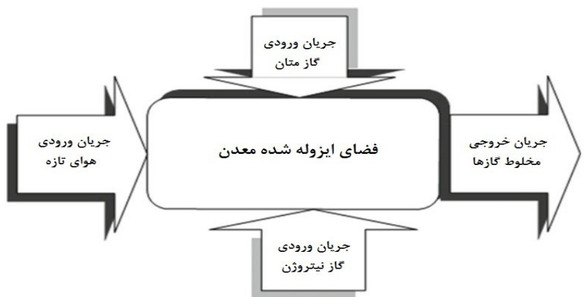
شکل ۱: تغییر ترکیب گازها در اتمسفر ایزوله معدن
