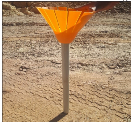
■ شکل ۳- پلاگ برای ایجاد فاصله هوایی در ته چال
