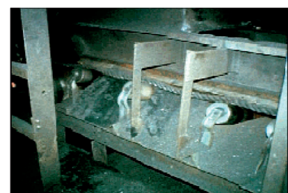
● شکل ۱ - انتشار گرد و غبار و ریزش مواد در شوت
