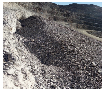
شکل ۸ - خردایش و نمودار دانه بندی مربوط به انفجار اول (Deck - B 1 - Z 1 )
