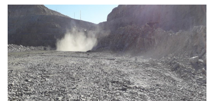
شکل ۶ - سطح بدون پاشنه انفجار سوم (Deck - Z 3 - B 3 )
