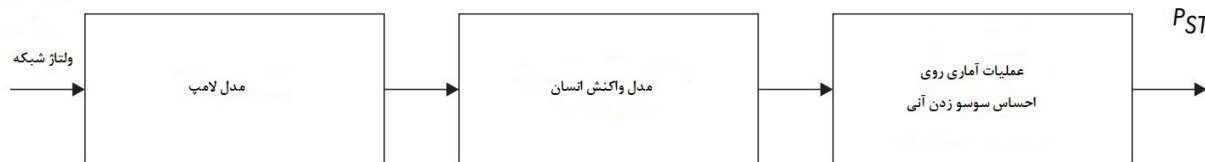
شکل ۴: عملیات تعیین شدت سوسو زدن
